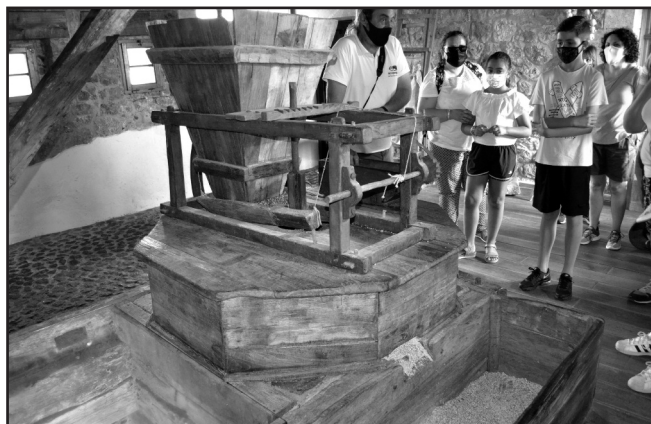
Tremuja, canalot i riscle (receptacle de les moles) del molí en funcionament. Al caixó de la dreta (fari-nera), s'hi veu el blat de moro ja molt.
