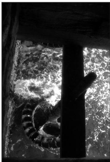
Amb l'obertura de comportes, la sortida de l'aigua amb força a través del canal activa els rodets.
