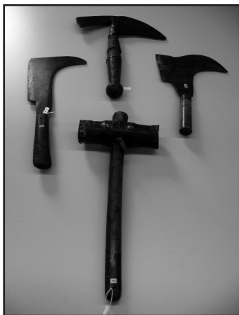
Unes poques eines utilitzades per mestres d'aixa i de calafat, seleccionades de la col·lecció de l'Ajuntament de Calonge i Sant Antoni. Fotografia: Esther Loaisa Dalmau
